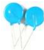
Hình 4.23: Thiết bị triệt xung hạ áp MFV 20D511K
