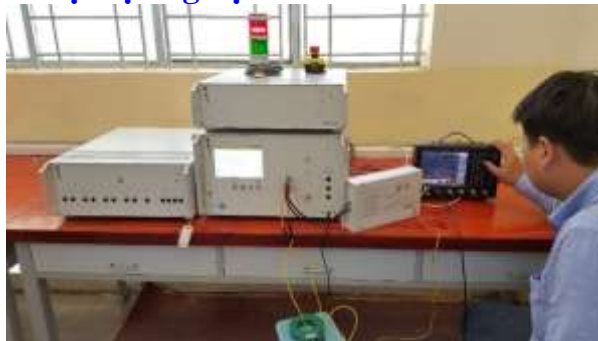
Hình 4.25: Kết nối thiết bị triệt xung hạ áp MFV 20D511K với hệ thống AXOS 8
